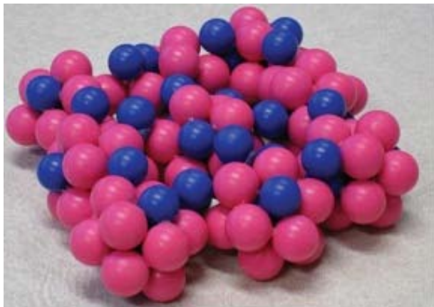
图 58. 用小球构建的非晶合金短程序团簇的照片, 图中红球代表溶剂原子, 蓝球代表溶质原子 [20]
