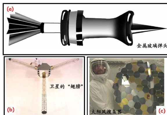
图 260. 非晶合金在军事及航天上的应用。(a) 非晶合金穿甲弹; (b) 卫星的非晶合金展开机构; (c) 非晶合金太阳风搜集器 [472]
