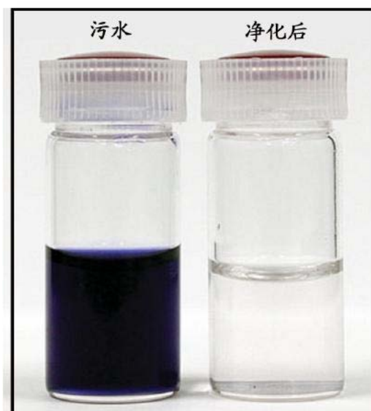
图 262. 铁基非晶合金粉末的污水净化作用 [488]
