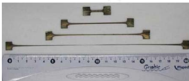
图 95. (上)Mg 基合金过冷液体应力-应变曲线,可以达到 800% 以上的拉伸应变 [243] ; (下) Ce 基非晶合金(金属塑料)在其过冷液态 > 1000% 的超塑性成形
