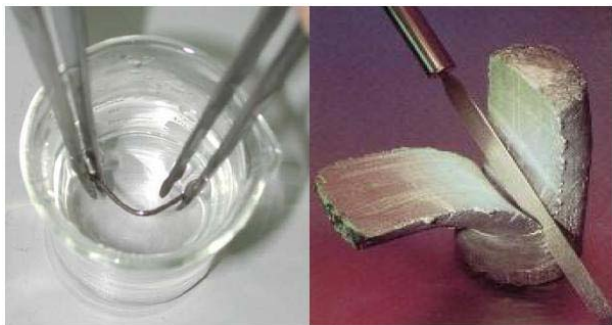
图 92. (左图) CeAlCu 非晶合金在其过冷液态(在开水温度就可以使之变成过冷液态)可很容易地进行各种变形 [79] ; (右图) Al 基合金过冷液体可以用餐桌刀像切面包一样进行切割(兰州理工寇生中教授提供)
