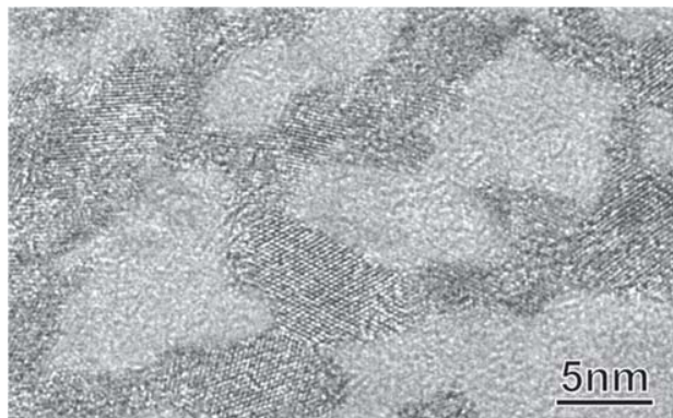
图 45. 高分辨电镜观察到的 \text{Pd}_{42.5}\text{Ni}_{7.5}\text{Cu}_{30}\text{P}_{20} 非晶的硬区和软区。在超声振动的作用下, 软区被晶化, 使得高分辨电镜能够分辨非晶的硬区和软区 [113]
