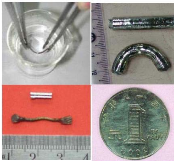
图 226. 金属塑料在开水中成型的示意照片。手指粗的金属棒可在开水中轻松弯曲; 在开水中拉伸; 在类似开水中这种简单条件下精确复写硬币的示意照片 [79]
