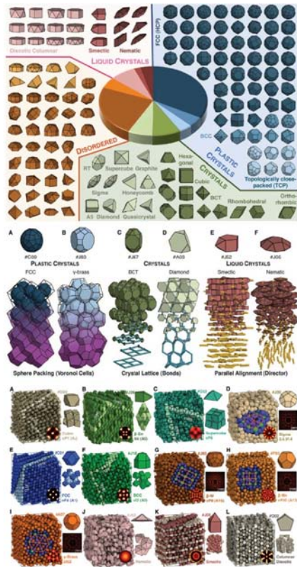
图 57. (上) 计算机模拟的各种具有短程序的多面体, 它们是很多物质的 building block; (中) 多面体自组装各种物质的过程; (下) 这些短程序的多面体自组装成的各种物质及其衍射图案 [222]
