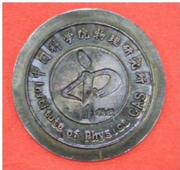
图 16. 金属塑料在开水中这种简单条件下压印的中科院物理所的所徽图案, 直径为 20 mm
