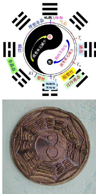
图 265. (上) 用中国古代的八卦图来示意非晶中脆性和塑性之间的辩证关系; (下) 用 Ce 基非晶金属塑料在开水中超塑性成型制备的八极图
